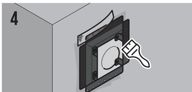
Загрунтуйте поверхность монтажной рамки, затем наложите поверх малярную сетку.
