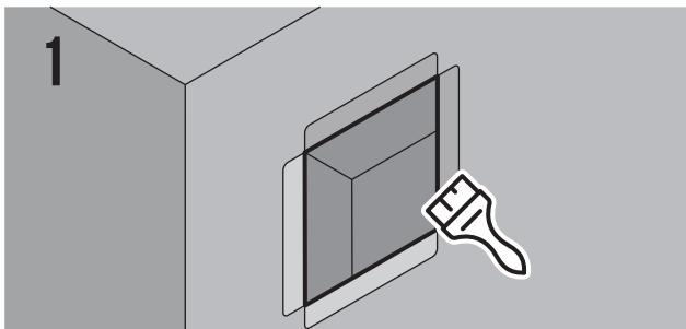
Перед установкой решетки требуется выполнить фрезеровку гипсокартонного листа под монтажную рамку на толщину металла и загрунтовать отфрезерованную поверхность.
