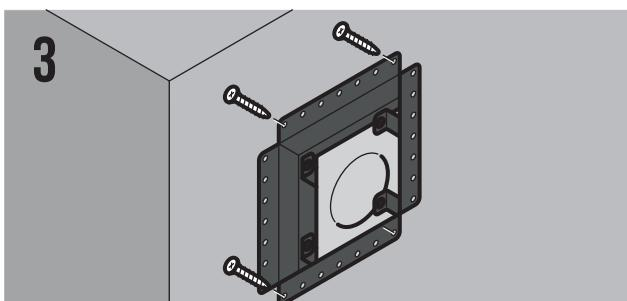
Убедитесь, что монтажная рамка плотно прилегает к поверхности. Закрепите корпус решетки саморезами по металлу с потайной головкой.
