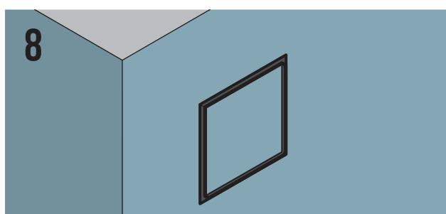
Установите лоток в корпус решетки. Для регулировки лотка вровень с поверхностью, используйте лапки на корпусе решетки. Готово!
