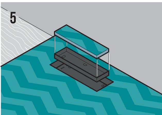
Вырежьте декоративный элемент для вставки в лоток в соответствии с геометрией и формой финишного покрытия.
