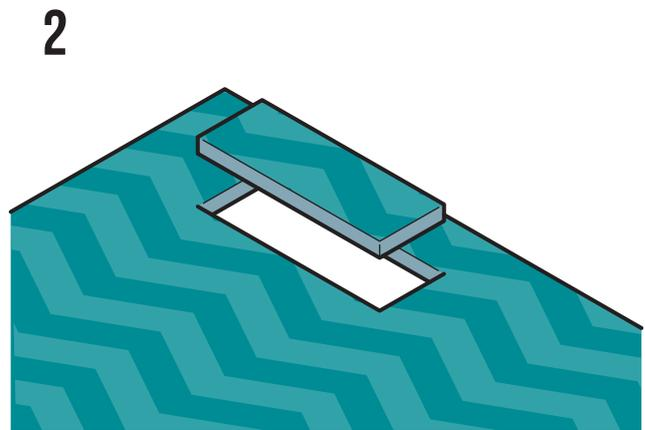
Аккуратно вырежьте в финишном покрытии отверстие по размерам регулировочной рамки. Сохраните вырезанный участок покрытия.
