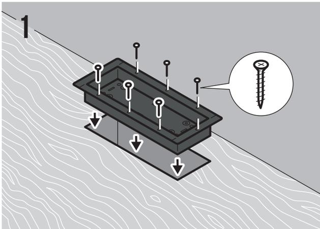
Установите корпус решетки в отверстие в черновой стене. Закрепите корпус винтами.
