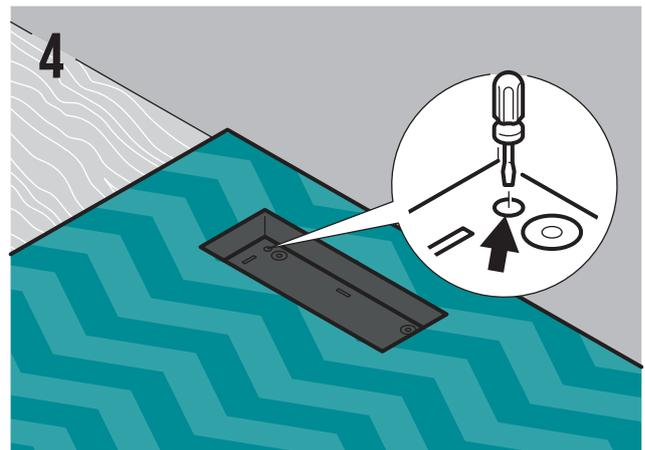
Используя регулировочные винты, выставьте рамку вровень с верхним краем финишного покрытия.
