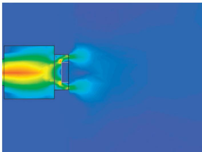
Распределение воздушного потока в решетке SCHIBERG ПРОФИ при подаче воздуха «сзади»
